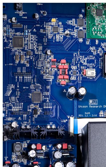
I convertitori corrente-tensione NE5532AD sono a del tipo “very-low distortion” e utilizzano componentistica di pregio: condensatori Wima e resistenze Vishay.
