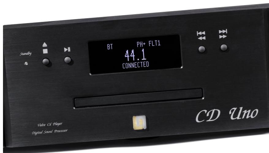
Il nuovo Display grafico bianco utilizza la tecnologia OLED per una ottima visibilità in ogni condizione di illuminazione e da ogni angolazione , ha una risoluzione 128 x 64. La funzione Display off permette di spegnere il display con la pressione di un tasto e godersi un ascolto senza illuminazioni. Sul display vengono visualizzate in caratteri grandi le informazioni principali, e in più piccolo le funzionalità attive.
